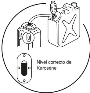
Llene su depósito con parafina. Para llenar el tanque, utilizar una bomba de trasvasije y observar el indicador de nivel del tanque durante el llenado. Deje de llenar cuando la parafina esté en la mitad del indicador de nivel.
